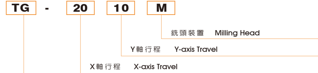
TG 槍鑽系列 - 三軸位移孔加工 TG Gun Drilling Series-Three Axes Feed Machining
