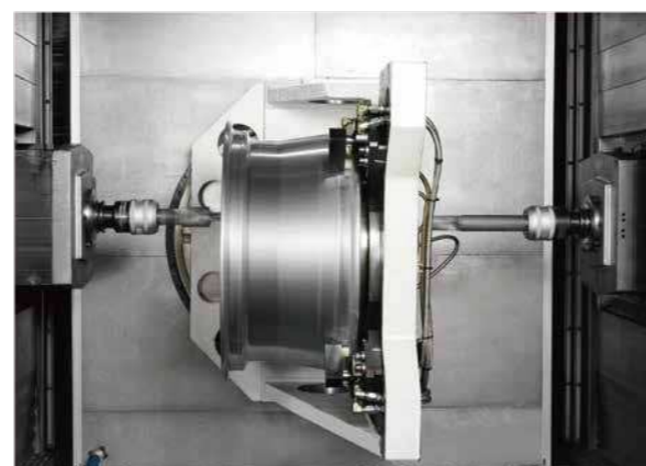
左右雙主軸設計，搭配180度翻轉機構，方便進行多角度加工。
